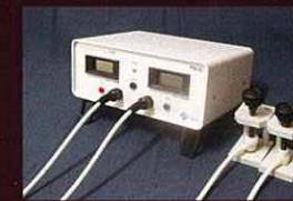
発汗計の電源を入れて試験環境に慣らす。
